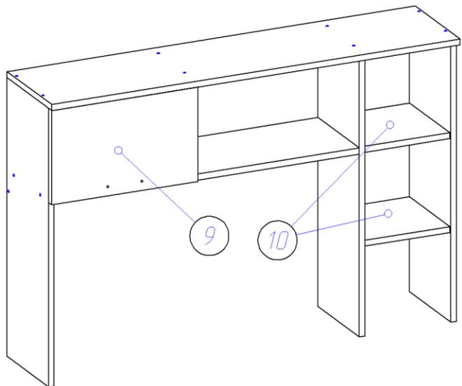
6. Устанавливаем изделие на столешнице стола, рассверливаем сверлом диаметром 7 мм глухие отверстия с обратной стороны столешницы и евровинтами 6,3\*50 крепим стоевые (1,2,7) к столешнице. Прибиваем заднюю стенку (ДВП) (11) гвоздями 1,2\*20.
